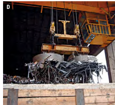
D Traversa con due elettromagneti serie ultra pesante "HMR" Ø 1650 mm per carica nastro alimentazione forno acciaieria. Beam with 2 electromagnets extra-heavy series "HMR" Ø 1650 mm for steel works furnace loading
